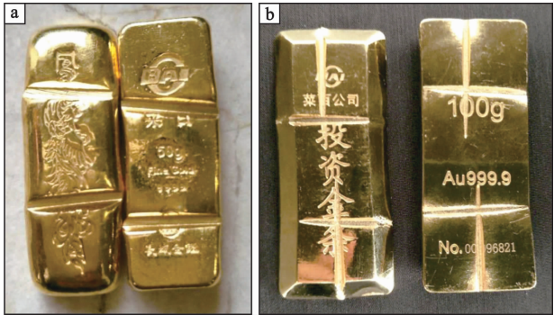
图 1 回购金条剪切位置示意图
