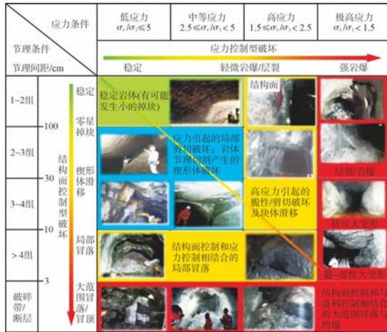
图2 以岩体结构分布与采动应力阈值为基础的岩体质量分类图表(JSI)
