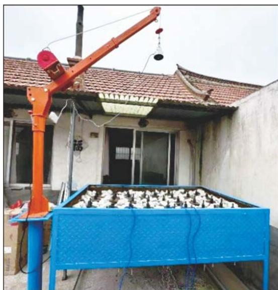
图 18 破碎岩体锚网支护动力冲击试验
