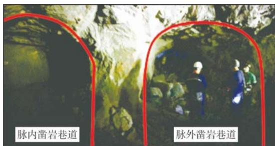
图9 采准工程布置现场
