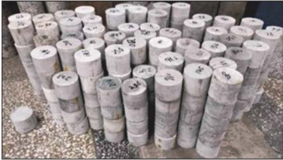
图 1 \phi 50\text{ mm} \times 40\text{ mm} 大理岩圆柱试样 Fig. 1 \phi 50\text{ mm} \times 40\text{ mm} marble sample
