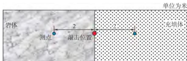
图 4 敲击试验传感器在岩体和充填体中的布置示意图
