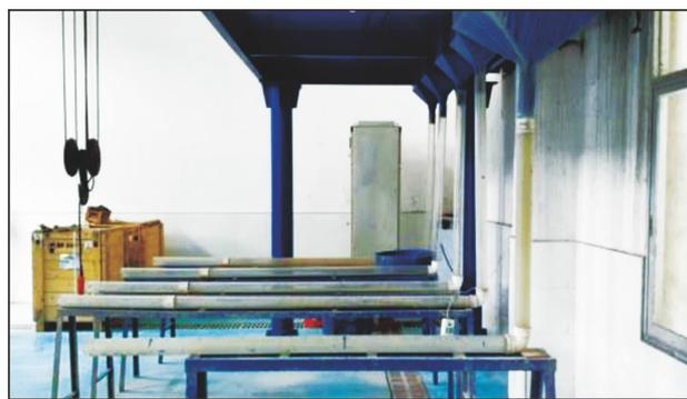
图5 L型管道试验装置
