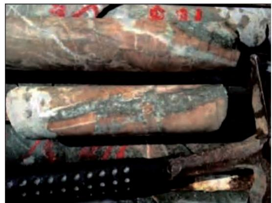
图7 砂金沟金矿床破碎蚀变岩型矿石
