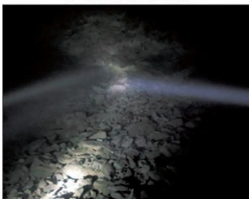
b) 二段回采爆破整体块度
