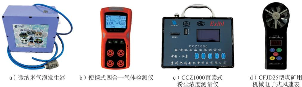
图3 快速空气净化试验仪器
